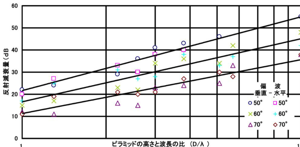
※ 電波吸収体の吸収性能の評価は、弊社における導波管法とNRLアーチ法によります。なお、測定は裏面が金属の場合です。
